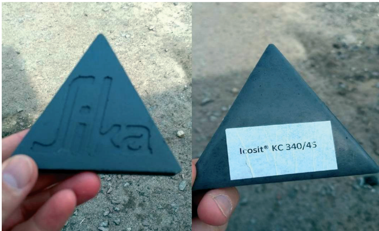
Рисунок – Зразок поліуретанового матеріалу Sika Icosit KC, який використовують для фіксації рейки в спеціальних каналах залізобетонних плит
