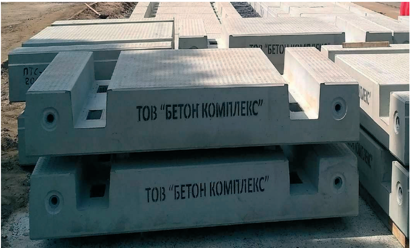
Рисунок – Конструкція трамвайної колії блочного типу з залізобетонними плитами ПТС-Е товщиною 350 мм виробництва компанії ПБГ «Ковальская», замінена в рамках договору на авторський нагляд
