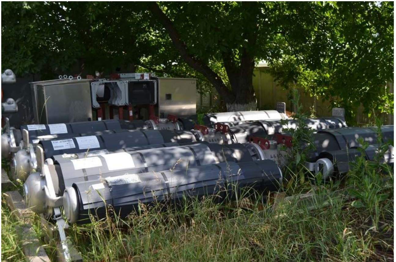
Світлина 4: Елегазові вимикачі 330 кВ виробництва «Siemens»
